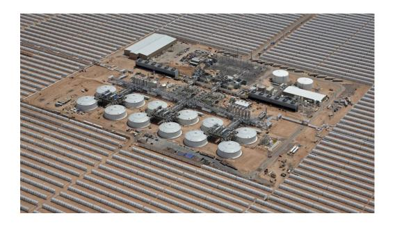
Abengoa operó con éxito una planta de demostración de almacenamiento térmico en sales fundidas, que luego se ha comercializado en Solana. El sistema de proporciona seis horas de almacenamiento térmico a la máxima capacidad.
