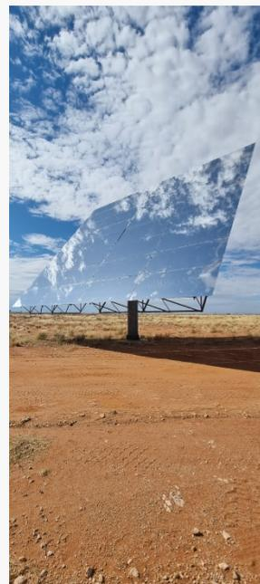
□ Heliostato construido con las nuevas facetas de fabricación Abengoa.
