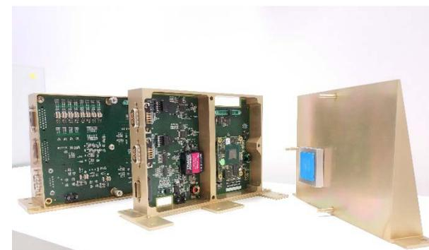
□ Vista interior de los módulos electrónicos de la Battery Diagnosis Unit (BDU).
