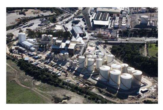
Está diseñada para operar con distintos tipos de aceites vegetales —soja, colza y palma— y así no depender de un único suministro. La planta es capaz de 200 000 t anuales de biodiésel que se utiliza en mezclas con diésel al 5 % en la refinería de Cepsa. La planta tiene capacidad de producir, también, 20 000 t de glicerina al año con una pureza del 85 %.
